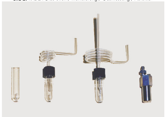
Bild 2: RADEX Glas offen / Inertisierung / Gasmessung / Autoklav
